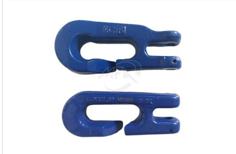
Crochet d'accrochage sans raccourci. Côté chape pour chaîne de débardage diamètre 8 ou 10 mm. Côté crochet avec fente en biais pour accrocher sur le câble porteur.
