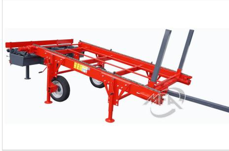
Le deck permet de stocker du bois suivant la version jusqu'à 6m de longueur. Les grumes sont chargées grâce à une grue ou tout autre moyen de levage. Les chaînes d'amenage amènent le tronc à couper vers des rouleaux de transferts qui envoient ensuite vers le combiné.
